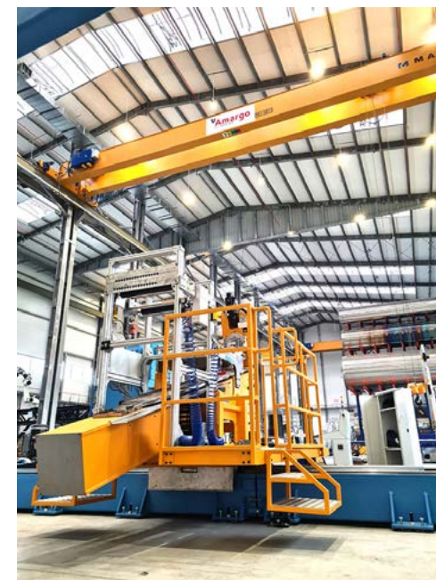
Technologia nawojowa (kompozyty) AmargTank Composite®
