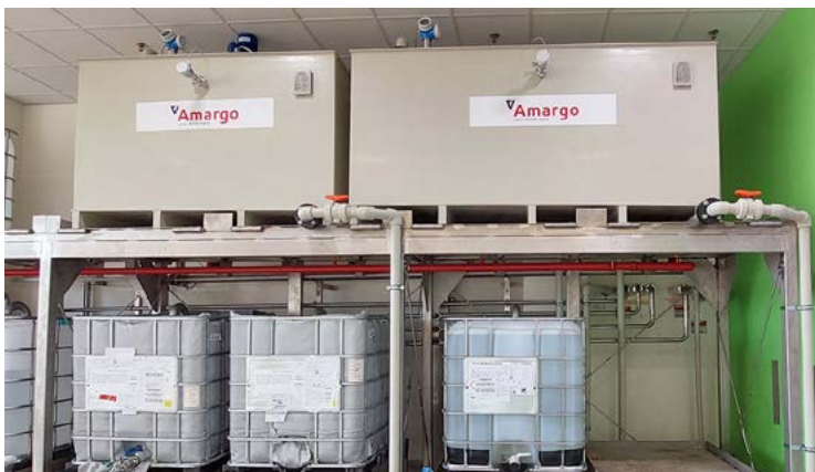
Zbiorniki pośrednie na Betainę i Aluminium Zirconium z instalacjami
